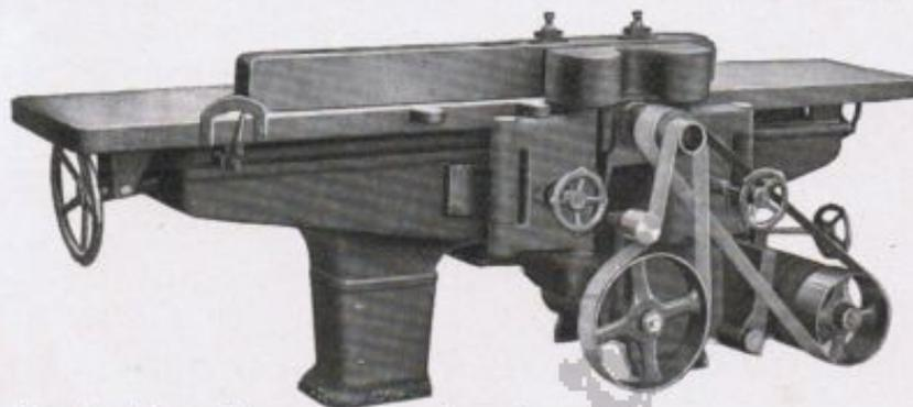
Die Maschine mit angebaurem Spundapparat,
