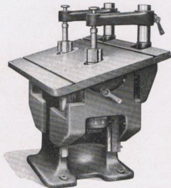
Einseitig bis 30 Grad schwenkbarer Tisch (nur bei Einbaumotoren)
