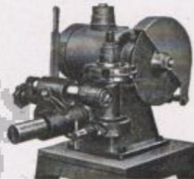
XFR Schleifmaschine für Hobelfräser von 60—220 mm  $\varnothing$  und bis 60 mm Breite.
